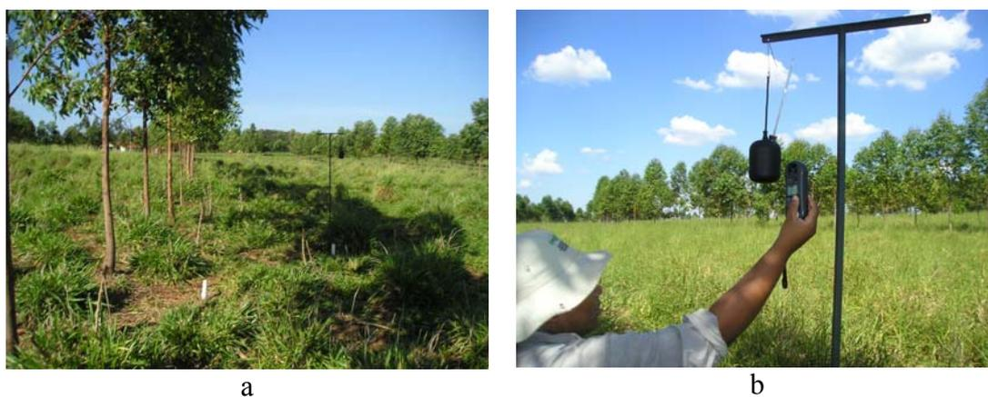
Figura 2. Estudo prévio do local de colocação do globo negro (a) e coleta das variáveis ambientais com o globo negro e termo-higro-anemômetro (THAL 300<sup>®</sup>) (b).
